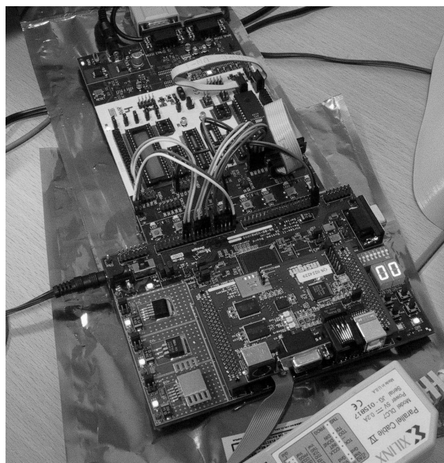
Figur 52: Virtex2 testkort med USBtransciever og STK500
